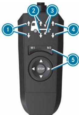
Panel obsługi (na przykładzie pojazdów z zawieszeniem w pełni pneumatycznym)
